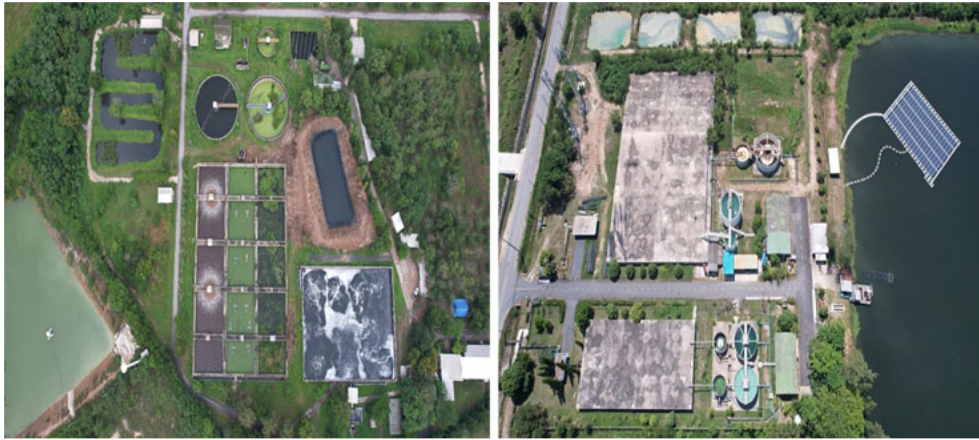
ภาพประกอบมีการผันน้ำที่ผ่านการบำบัดน้ำเสียกลับเข้าสู่กระบวนการผลิตน้ำประปาต้นน้ำ กลางน้ำ และปลายน้ำของคลองวังด้วน
